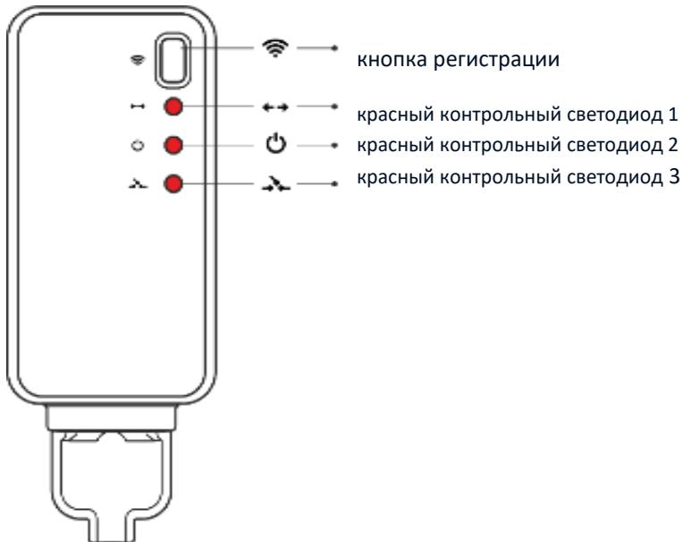
В приёмник встроены 3 контрольных светодиода:
