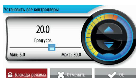
Существует тоже возможность блокировки режима работы данного комнатного регулятора. После включения блокировки пользователь, обслуживающий дополнительный контроллер не имеет возможности изменить заданную температуру или изменить режим на другой пока блокировка не будет выключена в контроллере М-6.
