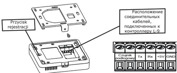
К стене нужно закрепить крепление регулятора R-9z а потом установить корпус.
