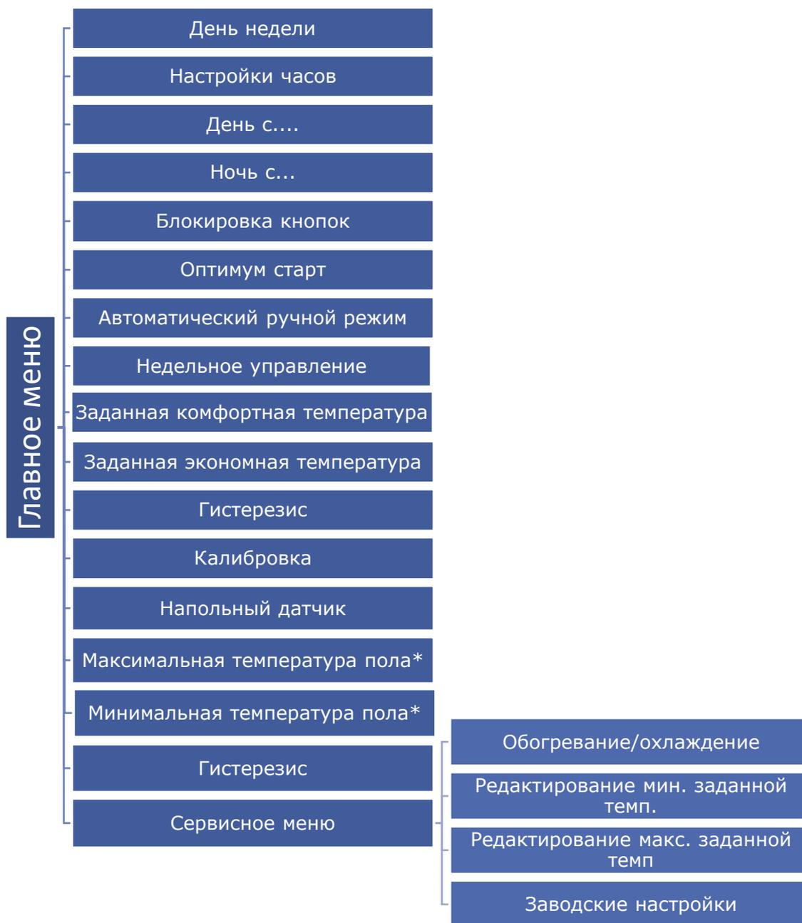
\* Функции отображаются в меню только после активации напольного датчика – нужно прикрутить дополнительный датчик к стыку напольного датчика и обозначить опцию ON в подменю Напольный датчик.
