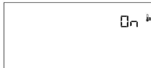
При помощи кнопки  $\checkmark$  или  $\wedge$  включаем напольный датчик – ON или выключаем его – OFF. Выбор подтверждаем при помощи кнопки МЕНЮ (подтверждение и переход к редактированию следующего параметра) или при помощи кнопки EXIT (подтверждение и выход на главный экран).
