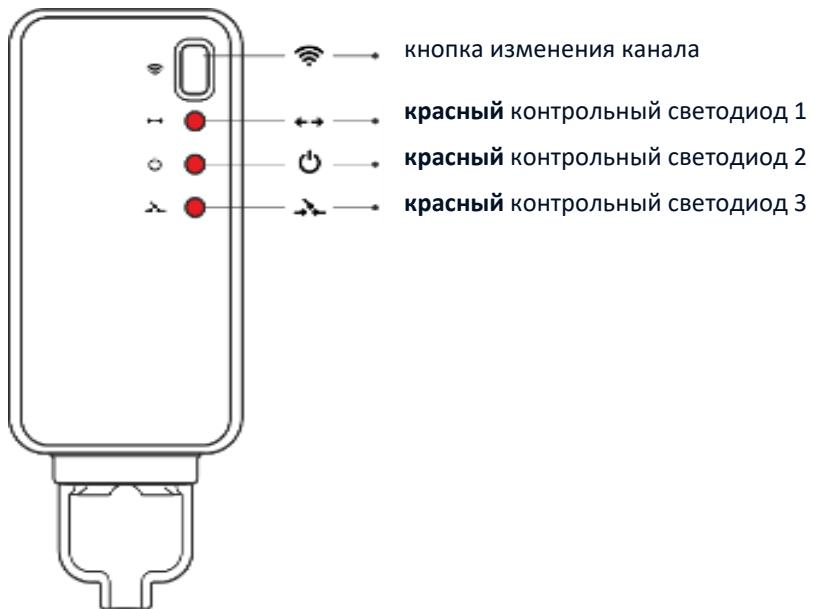
В приемник встроены 3 контрольных светодиода:
