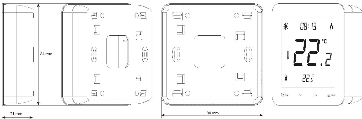
Для монтажа регулятора на стене, нужно прикрутить к ней заднюю крышку, вложить батареи и соответственно вставить переднюю часть регулятора.
