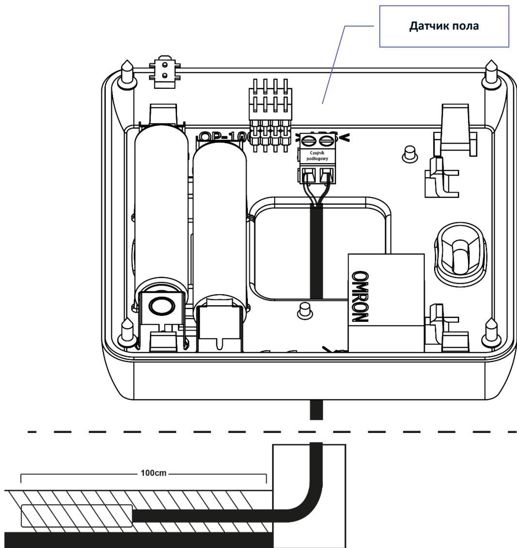
Комнатный регулятор нужно соединить с обогревательным устройством при помощи двухжильного кабеля. Схема подключения обоих устройств показана на схеме ниже:
